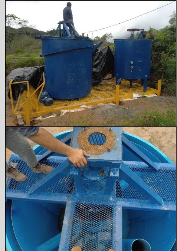
Todo el sistema esta construido sobre una plataforma autoportante sostenida por 6 gatos mecánicos y se transporta en un camión-grúa de 6 Tn de capacidad el cual es independiente de la plataforma.
